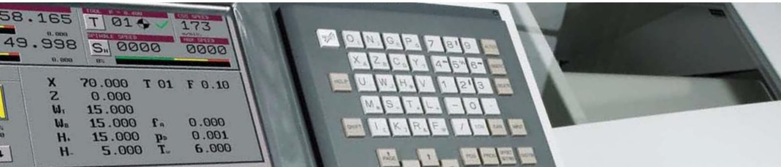
Manual Guide *i* ist die neueste und leistungsfähigste Dialogsteuerung von FANUC. Sie ist die umfangreichste Programmierhilfe, die sich ein Bediener wünschen kann. Durch einfaches Drehen des Wahlschalters steht sie dem Bediener zur Verfügung.
